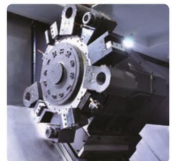
Die Revolver-Indexierung erfolgt nonstop und bidirektional, mit einer schnellen Indexzeit von 0,25 Sekunden zur nächsten Station.
